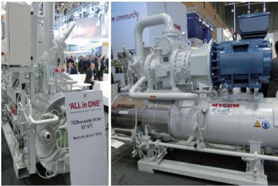
雪人股份旗下的瑞典 SRM 公司展示的 500kw 的冷水机组，供水 7°C，回水 12°C，液氨充注量仅为 19kg。
